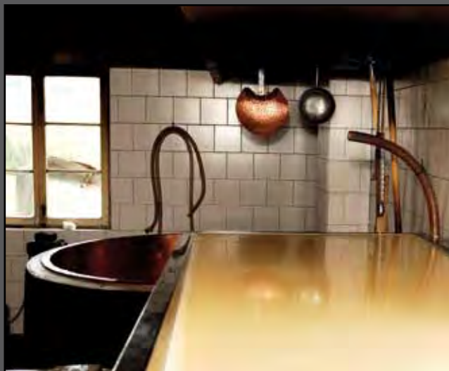
2. Vasca di affioramento in locale adatto
