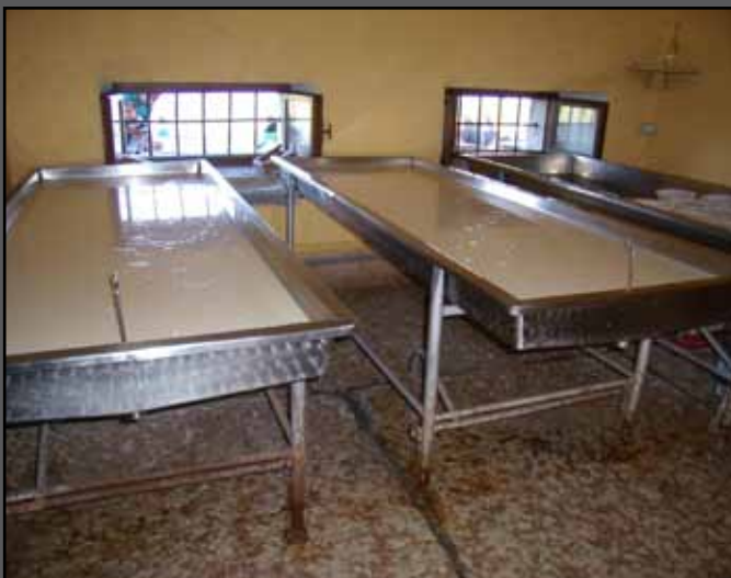
7. Vasche di affioramento
